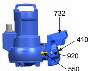
Rys. 14: Montaż zaczepu w przypadku przewodnicy 2-rurowej
