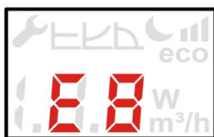
Rys. 14: Wyświetlanie komunikatu błędów E8 (błąd silnika)
