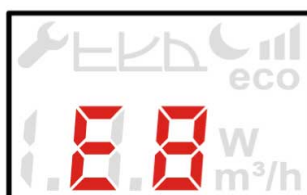
Rys. 14: Wyświetlanie komunikatu błędu E8 (błąd silnika)
