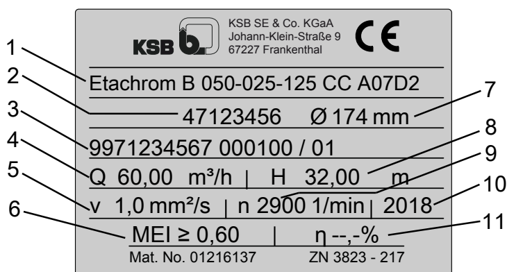
Rys. 6: Tabliczka znamionowa Etachrom BC (przykład)
